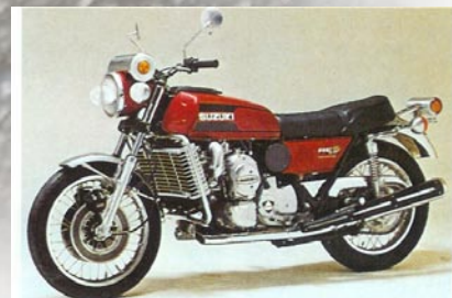
Suzuki RE 5 mit Wankelmotor, 1975.
